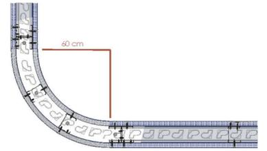
El techo continuo decorativo Pladur® Fon+ se compone de tabica vertical, faja perimetral a la misma altura, placa Fon+ de borde cuadrado y lana mineral. Las placas Fon+ deben colocarse en sentido transversal a la estructura secundaria.
