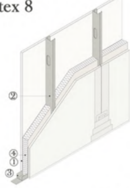
Detalle 2 Tabique de distribución con placa Pladur® Cementex 8
